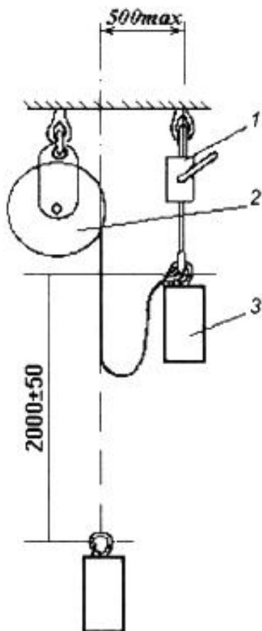
схема испытания УКСПа
