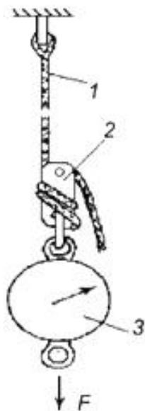
1 - канат; 2 - тормозное устройство; 3 - динамометр
