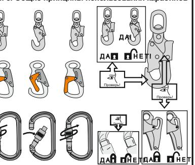
Рис. 6. Ограничения по способу приложения нагрузки относятся ко всем типам карабинов
